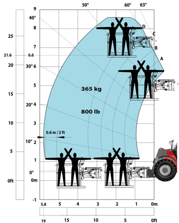
Máquina sobre neumáticos con cesta minera subterránea (Metric)
