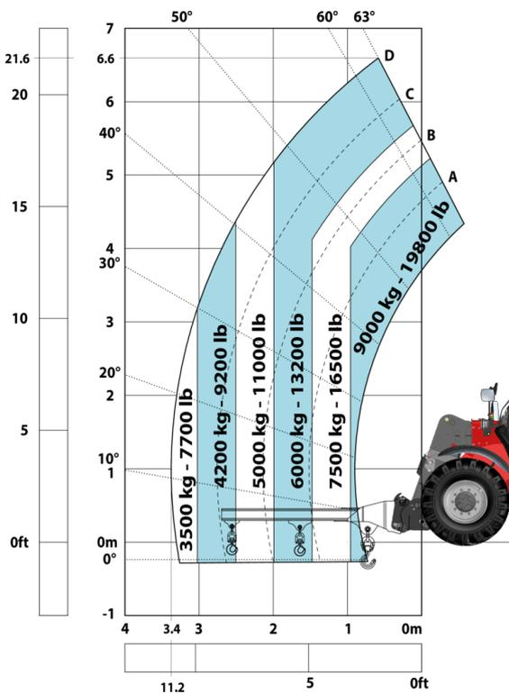
Máquina sobre neumáticos con plataforma
