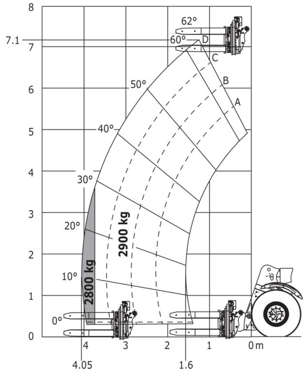
Máquina sobre neumáticos con manipulador de neumáticos TH 49 (Métrico)
