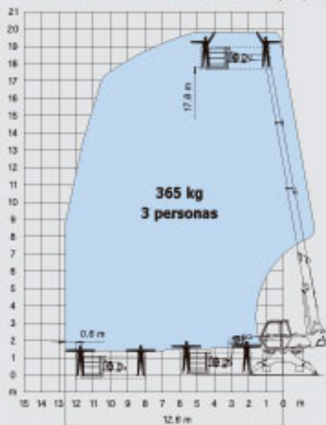
ROTACIÓN SOBRE ESTABILIZADORES CON PLATAFORMA ORH 365 KG - 2,25/4 m
