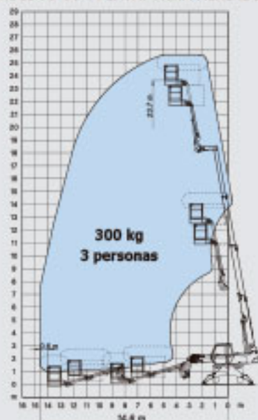
ROTACIÓN SOBRE ESTABILIZADORES TOTALMENTE EXTENDIDOS CON PLATAFORMA AERIAL JIB 1
